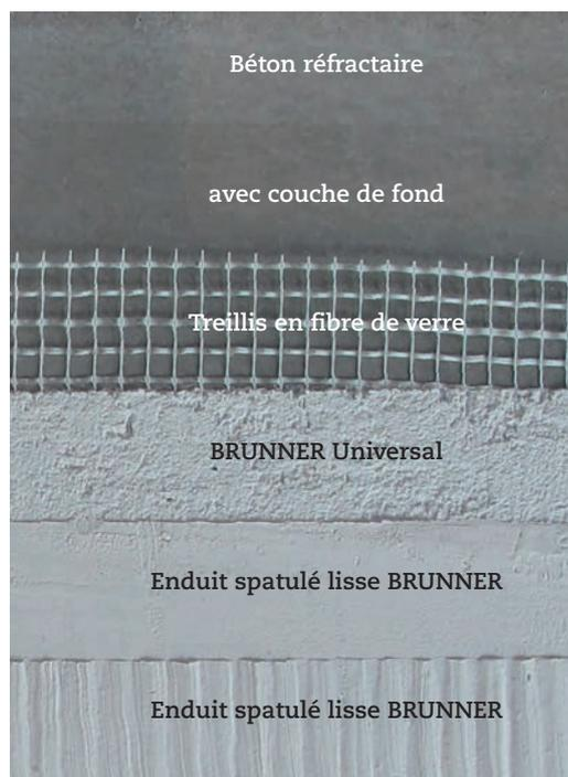
Surface d'enduit avec BRUNNER-Universal 600. La surface d'enduit en blanc naturel incorpore un treillis en fibre de verre d'une largeur de maille de 6 mm. La surface lisse et/ou structurée est obtenue avec l'enduit spatulé lisse BRUNNER.
