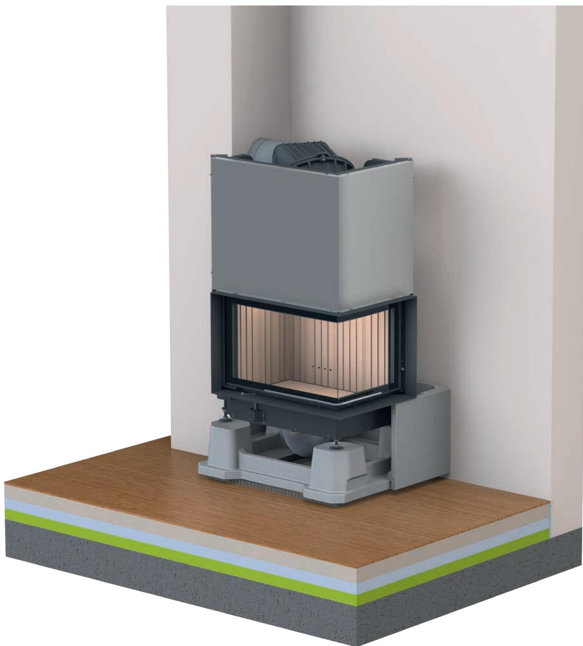
BSK 02 – Après alignement de la plaque de base, l'élément d'enveloppe est positionné au niveau de l'angle et le passage pour la conduite d'air de combustion est mis en place. L'insert de cheminée et les éléments annulaires suivants sont positionnés ensuite.
