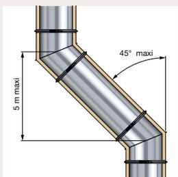
Pour les conduits de fumée individuels métalliques, les dévoiements ne sont autorisés que dans certaines conditions : le conduit ne doit pas comporter plus de 2 dévoiements dont la hauteur est inférieure ou égale à 5 m et sans excéder 45°.
