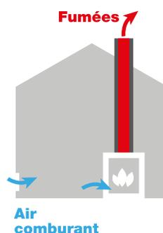
il prélève l'air comburant directement dans l'espace où il fonctionne par une grille ou une canalisation dédiée. Une amenée d'air doit être mise en place.
