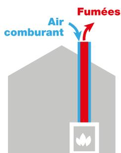
il prélève l'air dont il a besoin pour la combustion en dehors de l'espace où il fonctionne.
