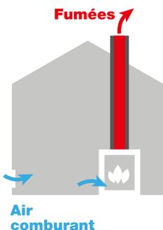
Un appareil **NON ÉTANCHE** prélève l'air comburant directement dans l'espace où il fonctionne par une grille ou une canalisation dédiée. Une amenée d'air doit être mise en place.
