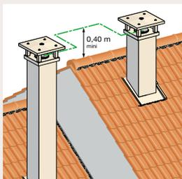
Le faîtage doit être situé à 0,40 m au moins au-dessus de toute partie de construction distante de moins de 8 m.
