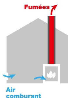
il prélève l'air comburant directement dans l'espace où il fonctionne par une grille ou une canalisation dédiée.
