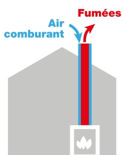
il prélève l'air dont il a besoin pour la combustion en dehors de l'espace où il fonctionne. Le conduit utilisé pour ce type d'appareil achemine alors l'air frais depuis l'extérieur jusqu'au foyer.
