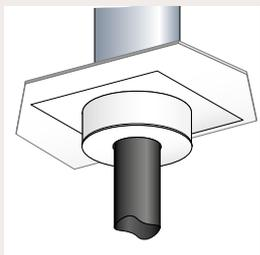
Le conduit doit déboucher dans l'intégralité de sa section extérieure dans le local où sera situé l'appareil ou la cheminée. La liaison ne doit pas se situer dans l'épaisseur du plafond ou dans le volume d'un faux plafond.
