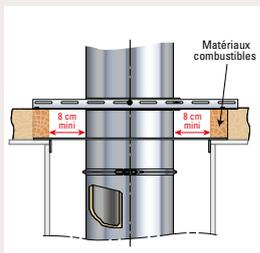
La distance de sécurité dépend de la résistance thermique du conduit et de la température des produits de combustion. La distance doit être au minimum de 8 cm dans tous types de construction. Certains conduits relèvent de l'avis technique (PGI = 10 cm, voir p. 181 Efficiencia = 5 cm, voir p. 161)
