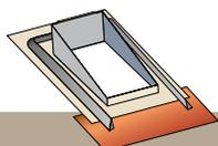
Embase étanchéité avec kit d'étanchéité\*\* (si tuiles inconnues ou plates)
