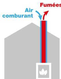
Un appareil **ÉTANCHE** prélève l'air dont il a besoin pour la combustion en dehors de l'espace où il fonctionne. Le conduit utilisé pour ce type d'appareil achemine alors l'air frais depuis l'extérieur jusqu'au foyer.
