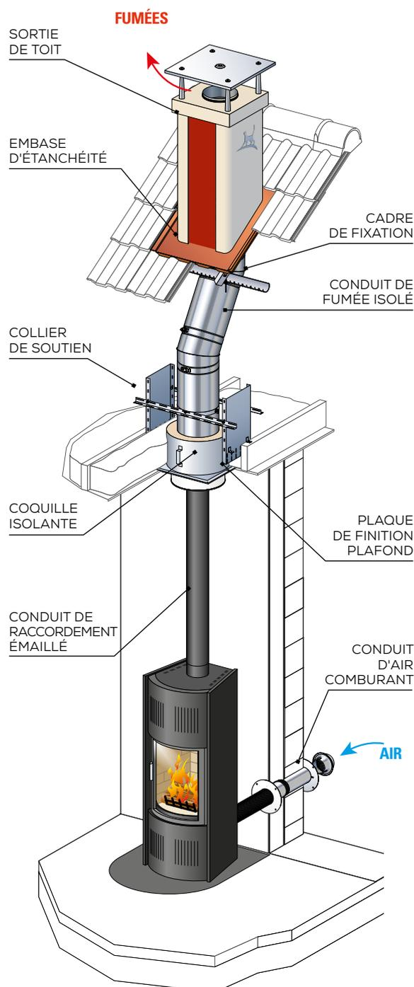
\* La Norme NF DTU 24.1 = Réglementation des conduits de fumée définit les règles spécifiques d'installation des systèmes d'évacuation des produits de combustion.
