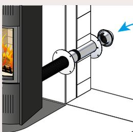
La prise d'amenée d'air comburant doit être située soit directement à l'extérieur, soit dans un local ou un espace ventilé sur l'extérieur. Si prise d'air direct sur l'extérieur, elle doit être placée dans la mesure du possible face aux vents dominants.
